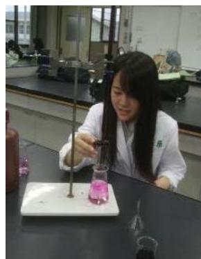
(図1) 過マンガン酸カリウム滴定法
