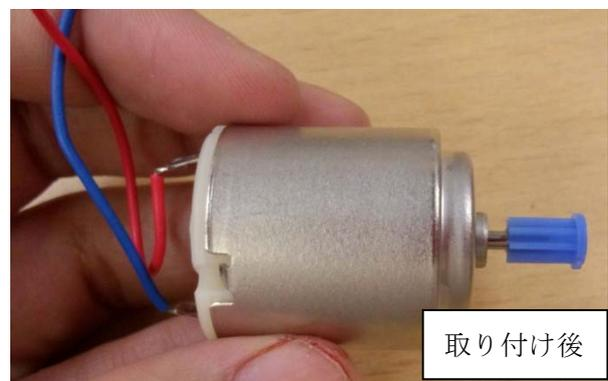
写真 10. ピニオンギア取り付け後
