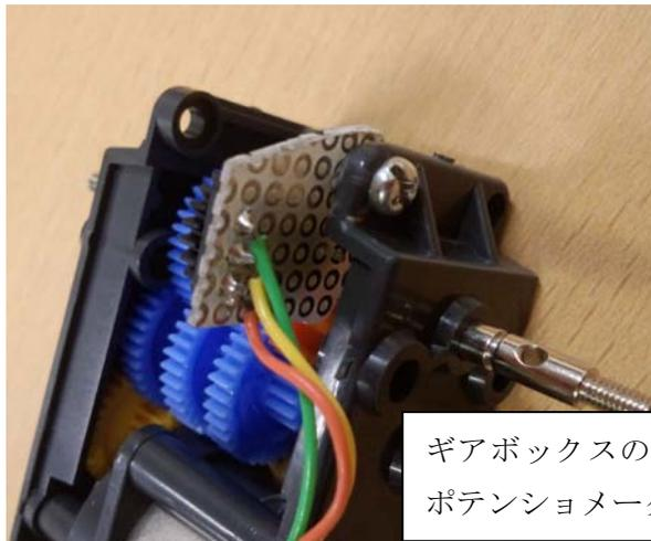
ギアボックスの切り落としたロッド部分にポテンシオメータをねじで取り付ける。
