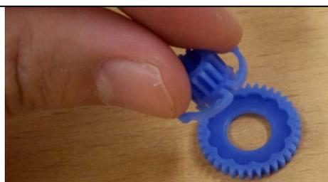
写真 14. クラッチ差し込み方
