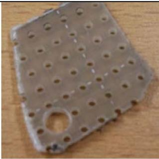
写真 28.ポテンシオメータ取り付け基板
