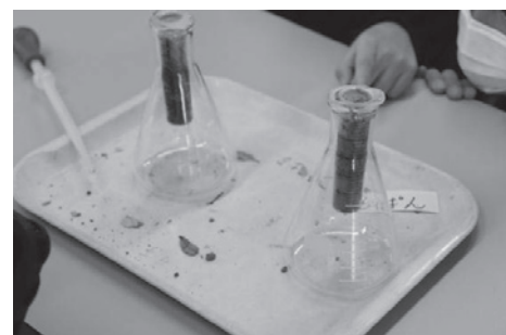
図6 地下水と泥水のろ過
