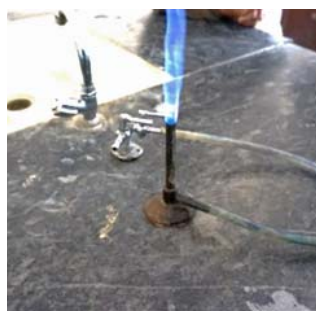
化学実験室とガスバーナー ガスバーナーはかなり古く、ガスが不足する冬は点きが悪い。元栓しかないガスバーナー
