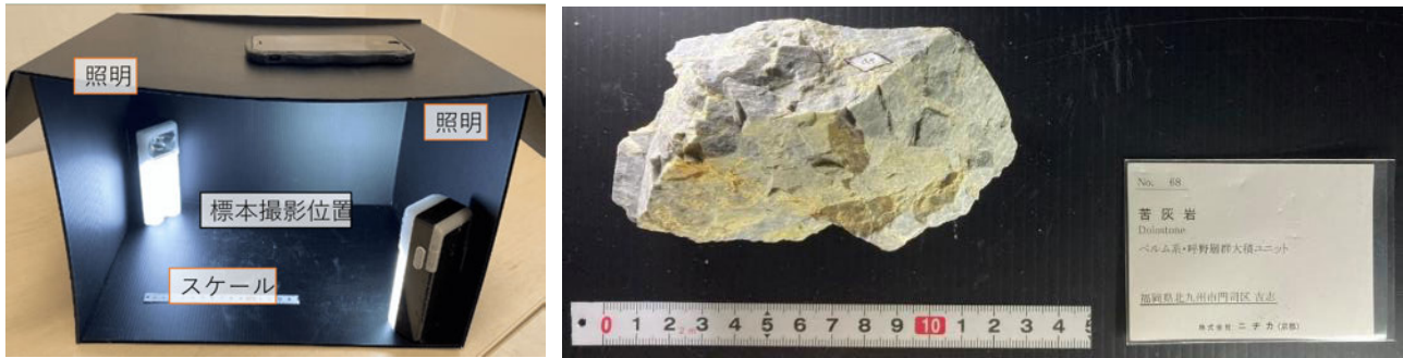
図 3. プラスチックダンボールを使用した岩石標本の撮影環境（左図）と撮影された岩石標本の例（右図）。
