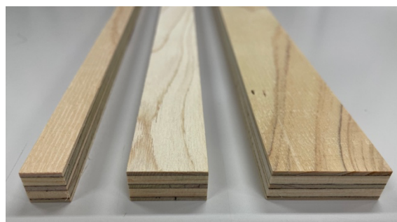
図 1 合板の規格材の断面図
