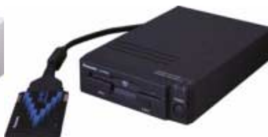
写真4 『120MB フロッピーディスクドライブ』と専用の『インターフェイスカード』
